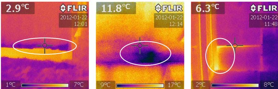
Die Wärmebilder zeigen Feuchteschäden in der Fassade (links), mangelnde Dämmung in der Decke (Mitte) und Wärmebrücken zwischen Kirche und Anbau (rechts)
